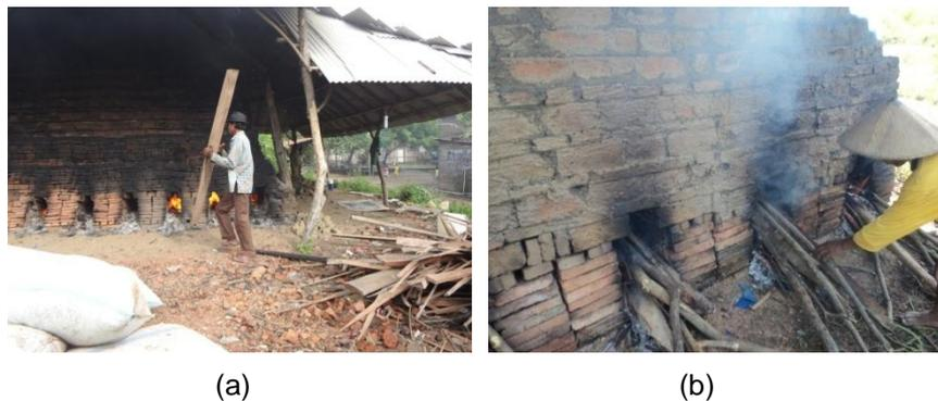
**Gambar 5.** Proses Pembakaran: (a) Proses Pembakaran Menggunakan Kayu Bakar; (b) Pengawasan Proses Pembakaran.
